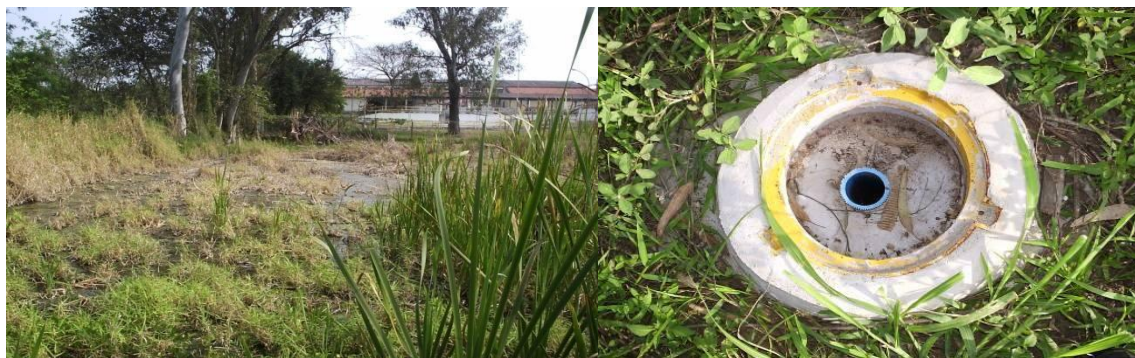
Figura 4 (E): Piscina de dejetos industriais encoberta por taboas ( Typha domingensis ). Nota-se eucaliptos à esquerda e ao fundo que morreram e secaram (Foto: Ivan Carlos Zampin, 02/2008). Figura 5 (D): Poço piezométrico localizado a dois metros da margem do Ribeirão Claro e a dez metros do início da piscina de decantação (Foto: Ivan Carlos Zampin, 02/2008).
