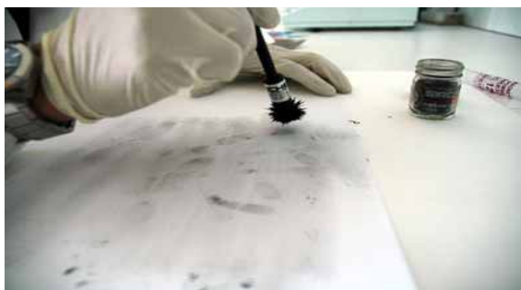
Figura 1: Ilustração da utilização do pó na revelação
