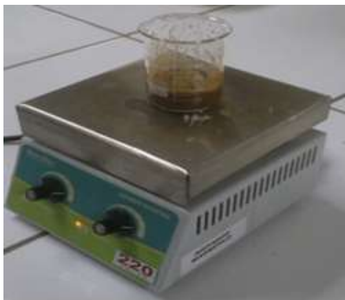
1-) Solução de pó de guaraná, HCl e NH 4 OH NH 4 OH no agitador magnético.
