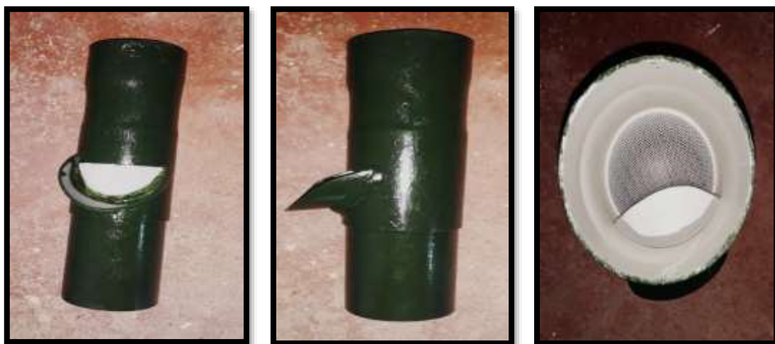
Figura 1 – Filtro I para filtragem grosseira.
