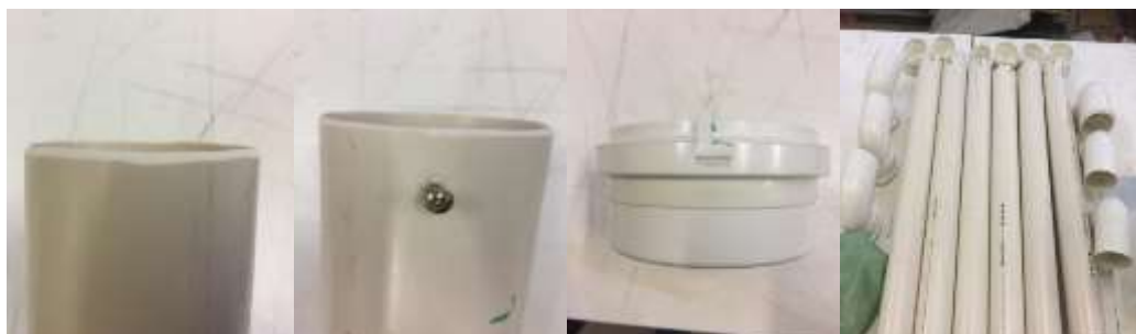
Figura 2 - Montagem das Bituqueiras.
