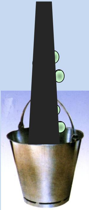
A leitura da densidade deve ser realizada na parte inferior do menisco formado pelo contato do mosto com a parte sobrenadante do densímetro.
